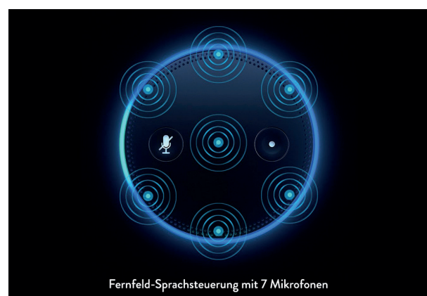
Abb. 2: Amazon Echo Dot – 7 Mikrofone, Quelle: Presse-Kit Amazon
